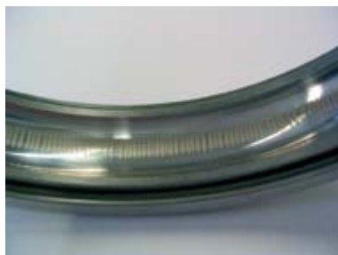
Obr.: Oběžná dráha vnějšího kroužku kuličkového ložiska se žlábkováním
