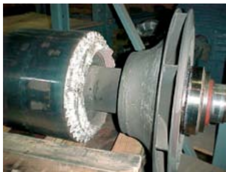
Obr.: vytavený ventilátor klece nakrátko.
