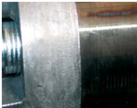
Obr.: zničená tyč rotorové klece.
