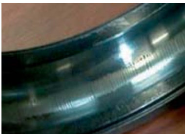
Obr.: Značkování/žlábkování oběžné dráhy paralelně s osou hřídele.
